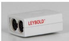
Permet de raccorder deux barrières lumineuses ( 33746 , 337462 , 337468 , 3374681 ou une barrière lumineuse combinée avec une roue à rayons combinée ( 337462 avec 337464 ) à CASSY.
