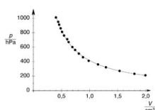
Pour étudier le comportement thermique des gaz (dilatation, augmentation de la pression), aborder la notion d'échelle des températures absolues et déterminer le zéro absolu. Tube capillaire ouvert à une extrémité, contenant un volume de gaz variable fermé par une gouttelette de mercure.
