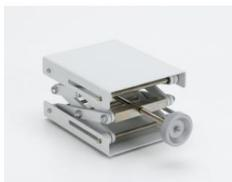
Support réglable en hauteur pour surélever les appareils de démonstration ainsi que pour faire varier la hauteur de certains appareils au sein d'un montage expérimental. Fixation avec quatre vis papillon.
