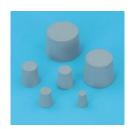
Pour tubes à essais de 180 x 20 mm et fioles Erlenmeyer (à col étroit, 50 ml et 100 ml).
