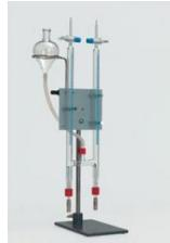
Voltamètre d'Hofmann, pour l'électrolyse de l'eau.
