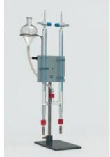
Voltamètre d'Hofmann, pour l'électrolyse de l'eau.
