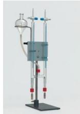
Voltamètre d'Hofmann, pour l'électrolyse de l'eau.
