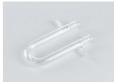
Pour l'électrolyse et le séchage des gaz
