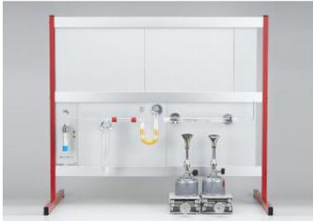
L'expérience C1.2.3.1 consiste à déterminer les rapports des masses du cuivre et de l'oxygène dans les composés oxyde de cuivre (I) et (II).
