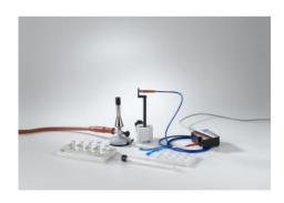
Les raies spectrales se forment lors du passage des électrons du niveau d'énergie supérieur au niveau inférieur dans l'enveloppe des atomes excités.
