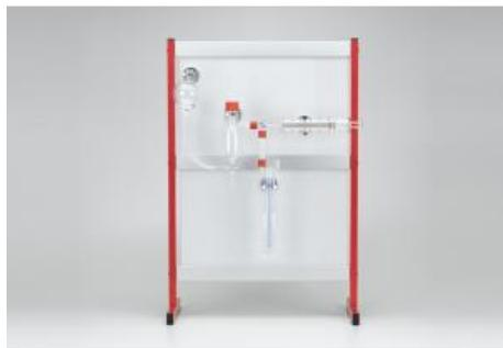
L'expérience C1.1.1.1 consiste à déterminer la masse molaire de certains métaux communs. Ceux-ci, par ex. le magnésium, sont mis en réaction avec de l'acide.
