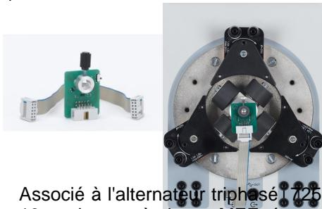
Associé à l'alternateur triphasé 726 721, le capteur permet de détecter la position du rotor à aimant MEE 563 19 et du rotor à aimant MEE tétrapolaire 563 191.
