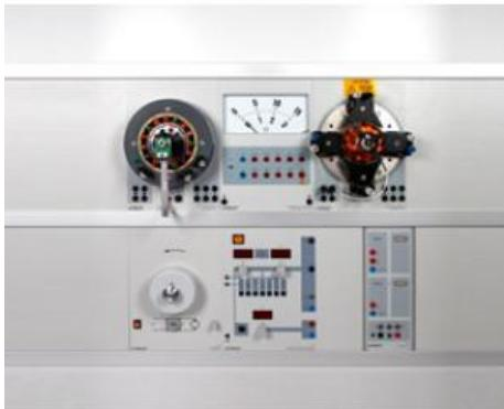
LEYBOLD utilise les composants de l'équipement Machines électriques d'enseignement (MEE) pour permettre à l'apprenti de réaliser soi-même les différents types de machine.
