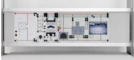
L'équipement A2.6.1.12 NUMÉRIQUE : SYSTÈMES VÉHICULES EN RÉSEAU "ETHERNET AUTOMOTIF" CAMÉRAS DE TERRAIN met à disposition la base matérielle pour une collection d'expériences permettant d'étudier la thématique de manière pratique.
