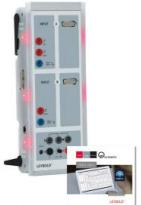
C'est une interface connectable en cascade pour l'acquisition de données.
