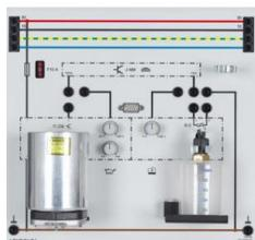
Capteur du niveau et de la température de l'huile ainsi que capteur de la température du liquide de refroidissement
