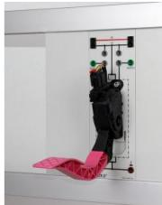
Capteur de pédale d'accélérateur d'origine moderne avec interface SENT (Single Edgeibble Transmission) selon SAE J2716 TM et résistance de rappel intégrée pour une expérimentation facile. L'interface SENT du capteur de pédale d'accélérateur prend en charge le mode de canal rapide pour la sortie des positions au format sécurisé 12 bits et le canal lent pour la sortie de données supplémentaires.
