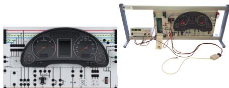
Combiné d'instruments avec compte-tours, tachymètre, affichage de la température et de la réserve de carburant, à affichage graphique haute résolution d'informations pour le conducteur.
