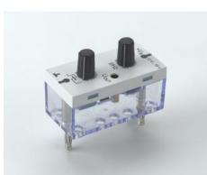
Élément enfichable STE 2/50 avec témoin du fonctionnement (LED) ainsi que 2 potentiomètres pour le réglage du rapport cyclique et de la fréquence pour la simulation du signal de vitesse de l'ABS ou de la durée d'injection  $T_{inj}$  pour les calculateurs automobile.
