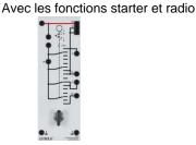
Commutateur d'allumage-démarrage avec trois niveaux et trois positions de commutation pour alimenter les bornes P, 75, 15 et 50.
