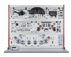
Avec la transmission d'un volume accru de données et la mise en réseau des composants électroniques utilisés en automobile, la gestion de l'éclairage et du circuit de charge dans un véhicule moderne est assumée par des calculateurs interconnectés par un réseau.
