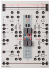
La Centrale électrique (ZE) est un module électrique centralisé dans lequel des parties du câblage d'automobile sont réunies pour fusionner des composants (bloc de fusibles) ou des relais de commutation. Il est utilisé pour la distribution centrale de la tension de batterie borne 30 et la tension connectée à la borne d'allumage borne 15 avec le contrôle d'éclairage conventionnel.
