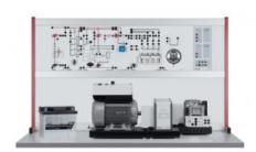
L'alternateur triphasé est une machine synchrone à champ tournant fonctionnant en génératrice. À l'aide d'un champ électrique, il produit une tension alternative triphasée variable en fonction de la vitesse. Comme le circuit de charge est conçu sous forme de réseau à courant continu, cette tension triphasée doit encore être redressée et qui plus est, régulée, puisqu'elle doit rester constante indépendamment du régime du moteur - cette tâche est assumée par le régulateur multifonction.
