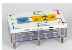
N?ud de bus CAN éducatif en tant qu'élément enfichable pour détecter un signal de capteur et générer un signal d'actionneur.
