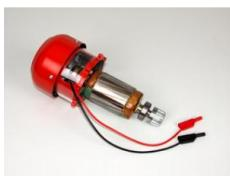
Le rotor est préparé à l'engagement dans le stator de modèle d'appareil 7747720.
