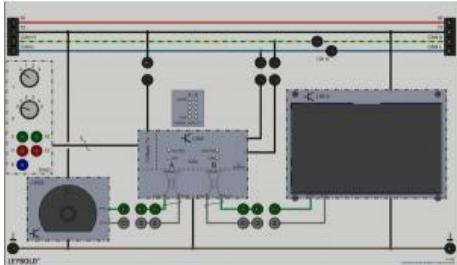
Cette unité contient un lien de transmission vidéo composé d'une caméra, d'une passerelle et d'un écran. communication entre la caméra et la passerelle ou la passerelle et l'écran se fait via une ligne à deux fils selon la norme 100Base T1, également connue sous le nom d'Ethernet automobile. autres désignations sont BroadR Reach ou OABR (Open Alliance BroadR-Reach).
