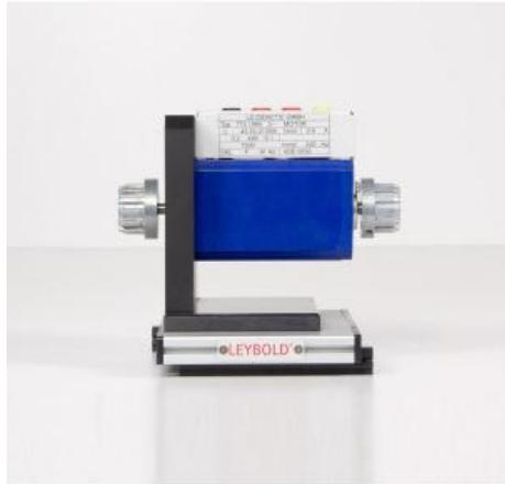
Moteur synchrone autopiloté tétrapolaire à aimantation permanente (sans balais), utilisable comme entraînement direct ainsi que pour la réalisation d'un asservissement de position ou d'un entraînement régulé hautement dynamique fonctionnant dans les quatre quadrants.
