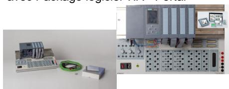
Il est composé d'une unité de base API (773070) et du kit d'entraînement composé de rail, bloc d'alimentation, CPU, entrées numériques, sorties numériques, entrées analogiques, sorties analogiques, câble de connexion Ethernet et progiciel TIA Portal.
