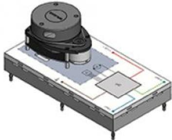
L'élément enfichable est utilisé pour les circuits construits sur les cartes enfichables DIN A4 ou DIN A3. Avec ce module, les bases de la détection d'obstacles peuvent être examinées à l'aide de systèmes optiques à laser.
