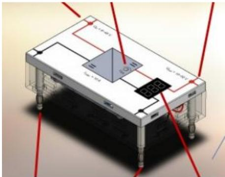
L'élément enfichable est utilisé pour les circuits qui sont montés par les élèves sur des plaques enfichables à grille.
