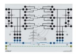
Simulation d'une ligne de transport triphasée 380 kV pour une mesure d'états de service stationnaires (marche à vide, adaptation, court-circuit).
