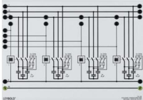
Permet de mettre en circuit ou hors circuit sur le réseau différentes capacités en vue d'une compensation de la puissance réactive.
