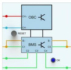
Ce composant, ainsi que le modèle "cellules" de batterie HV, 739 952, et le module STE Akku LiFe, 739 957, servent à protéger les batteries de la décharge et de la surcharge. Chaque cellule est contrôlée individuellement pour prendre les mesures appropriées.
