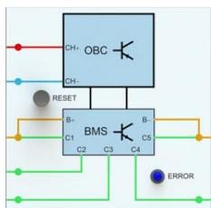
Ce composant, ainsi que le modèle "cellules" de batterie HV, 739 952, et le module de batterie STE Lilo, 739 955, servent à protéger les batteries de toute décharge ou décharge excessive.
