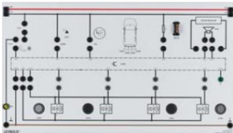
Le dispositif "d'aide au stationnement" de LEYBOLD ® est utilisé pour l'enseignement didactique de la fonctionnalité d'un assistant de stationnement car il peut être utilisé dans tous les véhicules modernes. Il comprend une nouvelle unité de contrôle d'origine capable d'un autodiagnostic, et quatre capteurs à ultrasons d'origine et est un prérequis pour la mise à niveau du système à l'assistant de stationnement dans l'automobile.
