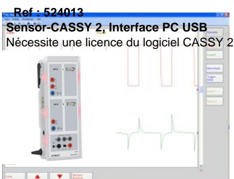
C'est une interface connectable en cascade pour l'acquisition de données.
