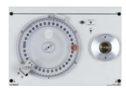
Remplace un moteur, avec volant d'inertie et arbre à cames, pour les systèmes d'allumage à distributeur (SZ, TZ-I, TZ-H), sans distributeur (DIS) et Motronic.
