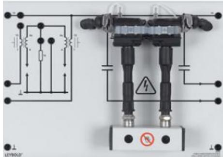
Plaque d'expérimentation avec deux unités d'allumage pour la représentation du fonctionnement d'un système d'allumage à bobines crayons unitaires. Sert à mesurer les paramètres suivants :
