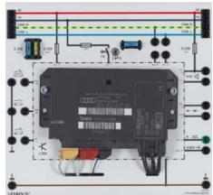
Original unit de commande d'automobile pour l'évaluation du commutateur des feux marche arrière et pour connecter un dispositif de test de diagnostic automobile (z. B. 7379803) via la prise OBD 738975 le système d'éclairage automobile avec bus CAN, 738111.
