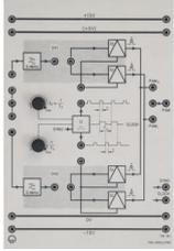
La modulation d'impulsions en amplitude (PAM) est réalisée par échantillonnage d'un signal analogique. Elle est l'étape préalable à la génération de signaux PCM (MIC).
