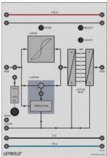
Dans le modulateur PCM (MIC), le signal échantillonné, à valeurs discrètes en temps, est quantifié et codé. À partir du signal d'entrée analogique du modulateur PAM, on obtient un signal entièrement numérique (à valeurs discrètes en temps et en amplitude).
