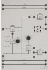
Grâce à leurs propriétés spectrales, les signaux PAM sont démodulés par des filtres passe-bas. Un étage d'échantillonnage et de maintien est souvent branché en amont pour augmenter le rapport cyclique. La plaque comporte toutes les unités de réception nécessaires à la réalisation d'un système de multiplexage temporel à deux canaux :
