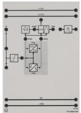
Le démodulateur PTM (MIT) reconvertit les modulations d'impulsions dans le temps PPM (MIP) et PDM (MID) en PAM (MIA).
