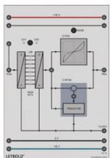
Le démodulateur PCM reçoit en série les données et le signal d'horloge transmis via une ligne de données commune (canal de transmission) par le modulateur PCM.
