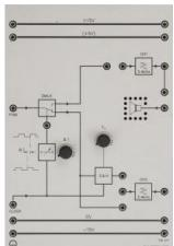
Grâce à leurs propriétés spectrales, les signaux PAM sont démodulés par des filtres passe-bas.
