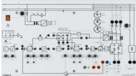
Convertisseur compact pour la variation, la commande et la régulation de tensions et courants continus. En plus d'un grand nombre d'essais, il permet la régulation de vitesse d'une machine shunt de 0,1 kW à 2,6 kW avec régulation en cascade du courant pour un fonctionnement quatre quadrants.
