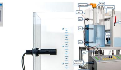
LC2030 Système de régulation de niveau, débit pour API ou régulateur externe, complet,
