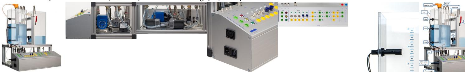
LC2030 Système de régulation de niveau, débit pour API ou régulateur externe, complet,
