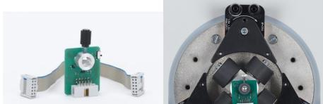
Associé à l'alternateur triphasé 725 721 , le capteur permet de détecter la position du rotor à aimant MEE 563 19 et du rotor à aimant MEE tétrapolaire 563 191.
