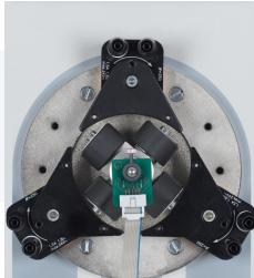
Associé à l'alternateur triphasé 725 721 , le capteur permet de détecter la position du rotor à aimant MEE 563 19 et du rotor à aimant MEE tétrapolaire 563 191.
