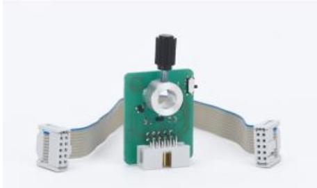
Associé à l'alternateur triphasé 725 721 , le capteur permet de détecter la position du rotor à aimant MEE 563 19 et du rotor à aimant MEE tétrapolaire 563 191.
