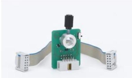
Associé à l'alternateur triphasé 725 721 , le capteur permet de détecter la position du rotor à aimant MEE 563 19 et du rotor à aimant MEE tétrapolaire 563 191.
