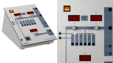
Le générateur triphasé est une unifié d'alimentation de laboratoire disposée dans un boîtier de table pour générer des tenstons continues, alternatives et triphasées pour l'alimentation des machines d'entraînement électriques (charges inductives résistives) basées sur des onduleurs..
