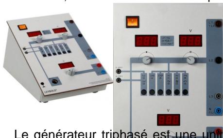
Le générateur triphasé est une unité d'alimentation de laboratoire disposée dans un boîtier de table pour générer des tensions continues, alternatives et triphasées pour l'alimentation des machines d'entraînement électriques (charges inductives-résistives) basées sur des onduleurs..
