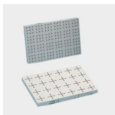
S'utilise en travaux pratiques pour la réalisation de montages expérimentaux électriques et électroniques. La surface d'une plaque A4 permet de réaliser des circuits à transistors à 3 étages à l'aide des éléments enfichables STE 2/19, 2/50 et 4/50. Peut également servir à agrandir les plaques de base et d'expérience pour les machines électriques d'enseignement.
