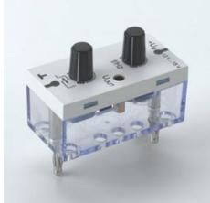
Élément enfichable STE 2/50 avec témoin du fonctionnement (LED) ainsi que 2 potentiomètres pour le réglage du rapport cyclique et de la fréquence pour la simulation du signal de vitesse de l'ABS ou de la durée d'injection T i pour les calculateurs d'automobile.
