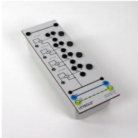
Extension pour une expérience supplémentaire avec le condensateur de démarrage contrôlé par la vitesse ou le courant par le système d'essai de la machine.
