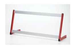
Cadre à un étage pour plaques d'expérimentation, hauteur DIN A4 ; version avec inclinaison d'env. 30° 2 rails profilés en aluminium avec deux bandes de calage 2 pieds en L en tube d'acier carré
