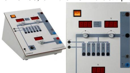
Le générateur triphasé est une unité d'alimentation de laboratoire disposée dans un boîtier de table pour générer des tensions continues, alternatives et triphasées pour l'alimentation des machines d'entraînement électriques (charges inductives-résistives) basées sur des onduleurs..
