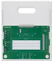
La carte de prototypage (Protoboard II) fait du Master Unit COM3LAB un environnement de développement pour les circuits électroniques. Des montages variés peuvent être réalisés et étudiés sur une grille conçue à cet effet.
