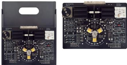
La carte d'expérimentation pour les cours COM4LAB sur les machines asynchrones, les machines synchrones et les machines à courant continu (disponibles séparément).
