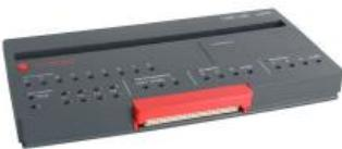
L'unité centrale COM4LAB est une interface de mesure compacte et multifonctionnelle. En tant que station de base universelle, elle assure le fonctionnement et l'alimentation électrique des cartes d'expérimentation COM4LAB.
