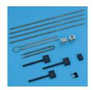
A utiliser avec l'émetteur d'ondes décimétriques (557 551), pour l'étude et la démonstration de la propagation des ondes électromagnétiques le long de fils ;
