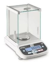
Grande chambre de protection en verre avec 3 portes coulissantes pour un accès confortable à la pesée. Dimensions compactes avantageuses pour gagner de la place. Utilisation aisée et pratique à 6 touches.
