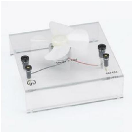
Avec hélice, sur socle transparent, avec 2 douilles de 4 mm et 2 douilles de 2mm de Ø. Tension de démarrage env. 0,2 V, courant de démarrage env. 4 mA, charge max. de 10 V.
